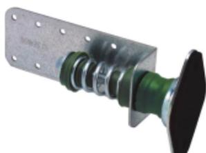
Isolateur acoustique pour la fixation de cloisons aux murs de structure existants en béton ou en maçonnerie. Cette fixation souple est composée d'une entretoise métallique et d'un corps formé de la combinaison d'élastomère (EPDM) et d'un ressort métallique. De par la présence du ressort, cet isolateur est particulièrement adapté à l'isolation de basses fréquences.
