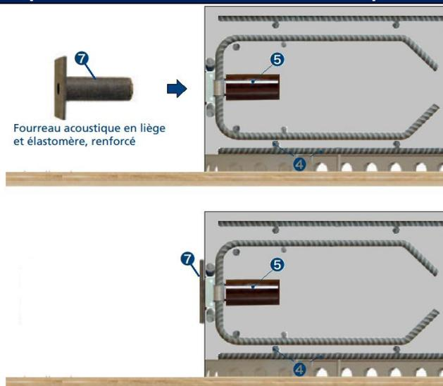
Fourreau acoustique en liège et élastomère, renforcé
