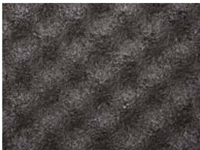
Según el resultado deseado se aconsejará utilizar una lámina ondulada o plana. Para conseguir la frecuencia de resonancia exigida, se pueden superponer varias capas de Isomat. Las láminas están hechas con granulados de caucho adheridos con poliuretano y son totalmente imputrescibles y resistentes a la humedad.
