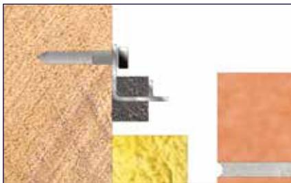
Fijación con tornillo para madera
