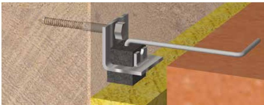
La extremidad del gancho del bloque acústico tiene que ser visible
