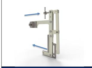
Serrer la vis en partie supérieure du GDR jusqu'à ce que la rive soit bien en contact avec le voile béton, et que le joint mousse soit bien comprimé.
