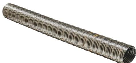
Le tube ANKROBOX flexible à petites nervures est une gaine en acier brut obtenue par le façonnage en spirale d'une tôle en acier laminée à froid selon la norme DIN 1624/1544 ST3 ou ST4-F13 avec 4 ondulations par 32 mm.
