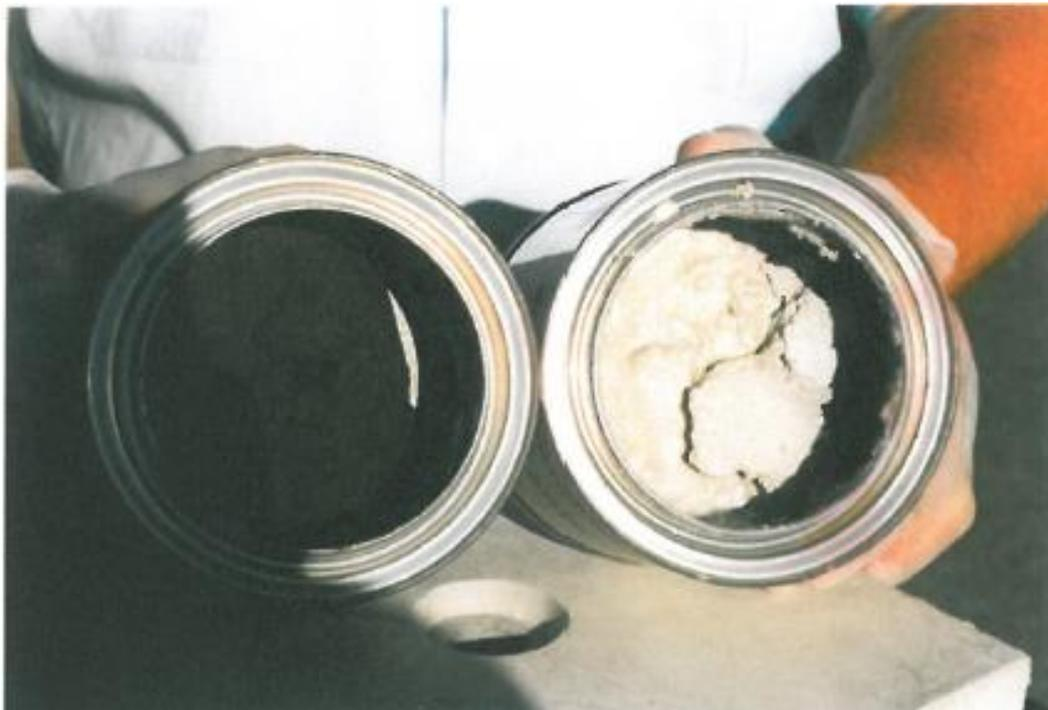
Image 4 : composant B (noir) et composant A (clair) de la colle 15/56 dans les quantités livrées, avant le mélange dans la boîte droite.
