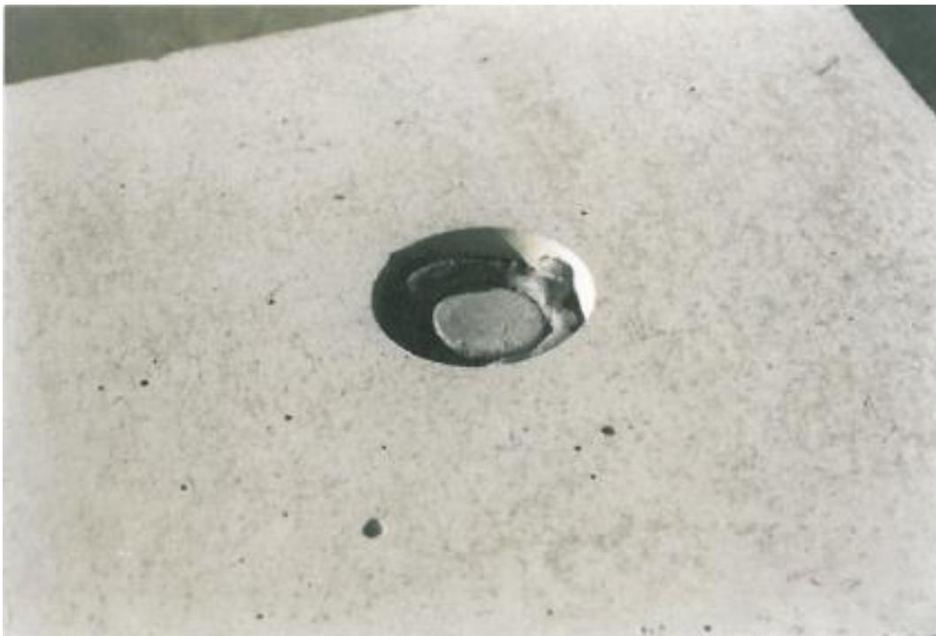
Image 6 : état final des bouchons en béton fibré collés
