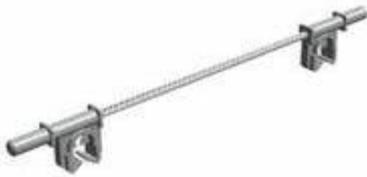
L'écarteur réalisé à partir d'une barre d'armature en acier avec des écarteurs de fixations en plastique pressés à chaque extrémité de la barre, peut être utilisé sur des barres de max. de 12 mm de diamètre.
