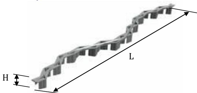
Sinap est un écarteur continu de grande surface d'appui, en forme de "zig-zag", destiné à assurer un écartement déterminé entre le panneau de coffrage et le lit inférieur d'armatures.
