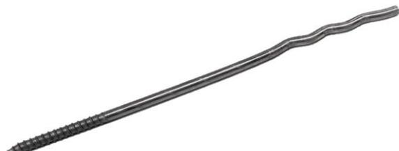
Le crochet de maçonnerie pour ossature bois est droit et possède une extrémité filetée, permettant un ancrage dans la structure intérieure en bois. Le crochet est muni d'un filet à bois et se visse immédiatement dans l'ossature. L'ancrage dans la maçonnerie est prévu grâce à une ondulation à son autre extrémité.
