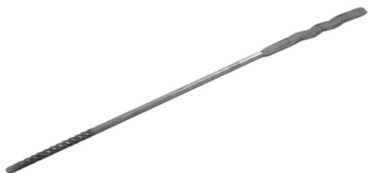
Le crochet de maçonnerie pour brique collée possède une extrémité torsadée et l'autre ondulée et aplatie. Le côté torsadé est ancré dans la structure intérieure au moyen d'une cheville. Le côté ondulé plat, avec une épaisseur d'environ 2mm, est placé dans le joint de la maçonnerie de parement.
