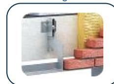
tous les deux ou trois joints ou tous les 20 cm maximum. Pour la suspension des briques horizontales, les crochets spéciaux doivent être combiné avec des goupilles dans les briques.
