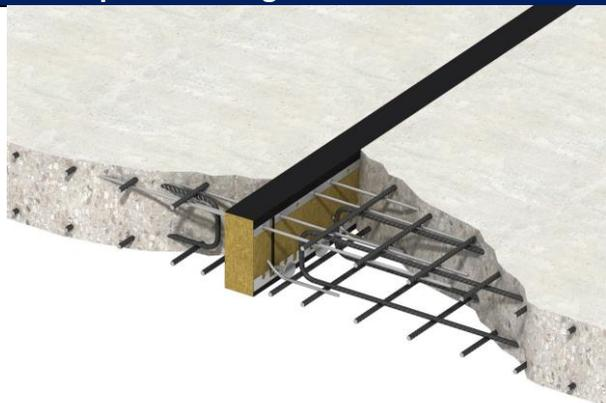
Le béton doit être coulé simultanément de part et d'autre de l'Isotec, afin d'éviter tout déplacement éventuel du rupteur thermique.
