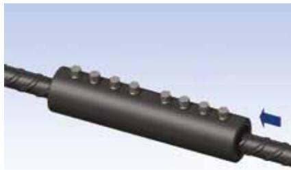
Introduire la deuxième armature dans le manchon jusqu'au contact de l'autre barre. Serrer les vis de pression à la main jusqu'au contact de l'armature. Vérifier l'alignement et faire les corrections nécessaires.
