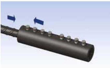
Enfiler le manchon sur l'armature. Celle-ci doit pénétrer jusqu'à mi-chemin du manchon avec une tolérance de  $\pm 6$  mm. Serrer les vis de pression à la main jusqu'au contact de l'armature. Vérifier l'alignement et faire les corrections nécessaires.
