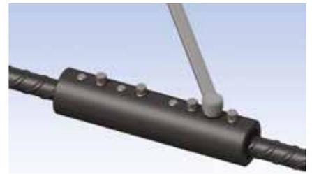
Compléter le serrage des vis de pression à l'aide d'une clé à cliquet ou d'une visseuse. Ne pas utiliser de clé à chocs. Serrer les vis de façon alternée (d'abord une vis sur deux, puis les vis restantes) jusqu'à rupture des têtes.
