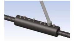
Finalizar el apriete de los tornillos de presión con la ayuda de una llave tipo "carraca" o una atornilladora. No utilizar una llave de golpes. Apretar los tornillos de modo alternado (primero los tornillos 1,3,5 y luego los otros 2,4,6) hasta llegar a la rotura de la cabeza.
