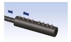
Colocar el manguito sobre la armadura en espera. Comprobar que la armadura entra hasta la mitad del manguito con una tolerancia de 6 mm. Apretar los tornillos de presión manualmente hasta hacer contacto con la armadura. Verificar la alineación entre barras y corregir si fuera necesario.
