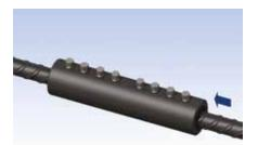
Colocar la segunda armadura dentro del manguito hasta hacer contacto con la primera armadura. Apretar los tornillos de presión llegando hasta la armadura. Verificar la alineación entre barras y corregir si fuera necesario.
