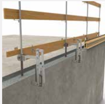
La rive est posée sur le bord du mur et glissée. La pose se fait idéalement à partir de la plateforme de travail
