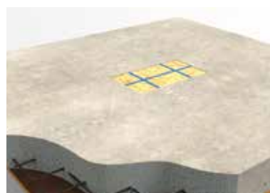
Storten van de plaat. Afdekking gelijke hoogte met het oppervlak.
