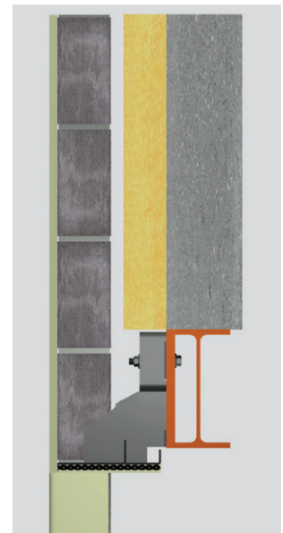
Strekmetaal gelast aan het hoekstaal om een goede hechting van de bepleistering te verkrijgen
