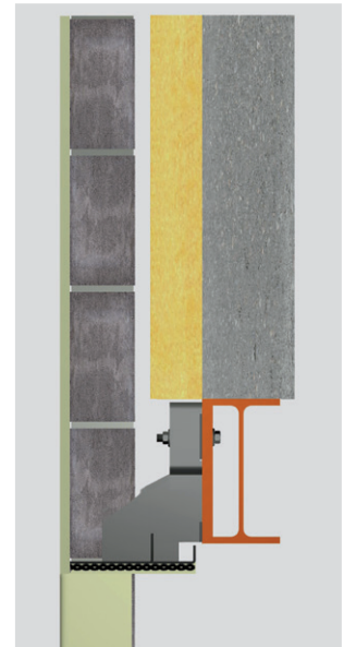
Métal déployé inox soudé en sous-face de la cornière pour une bonne adhérence du crépi
