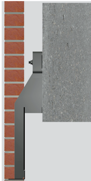
Console avec batée renforcée (section en "T" ou en "L")
