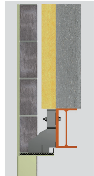
Con malla inox soldada sobre angular para adherencia del hormigón
